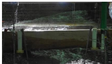
写真8 波が防波門を押し切った時点 (3.6秒後)
