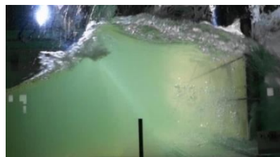
写真3 防波扉が波を押し戻している時点 (0.9秒後)
