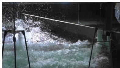
写真7 波が防波門を押している時 (1.1秒後)
