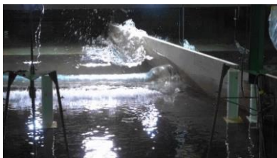
写真6 波が防波門を押し始めた時点 (0.5秒後)
