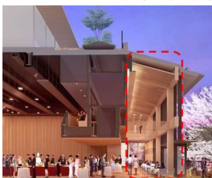
図3 吹き抜け部断面 (資料: 同上)
