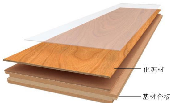
図1 一般フローリング構成図
