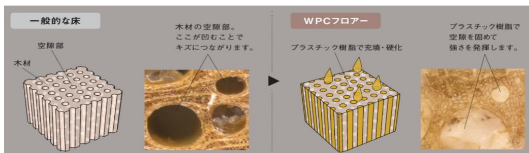
図 4 WPC 加工イラストとマイクロスコープ画像
