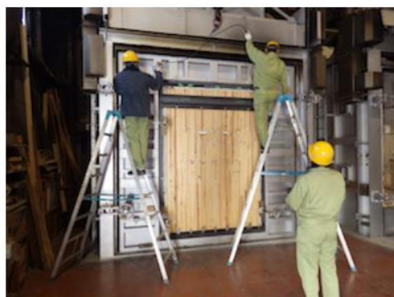
写真2 加熱終了後の様子(加熱開始後70分)
