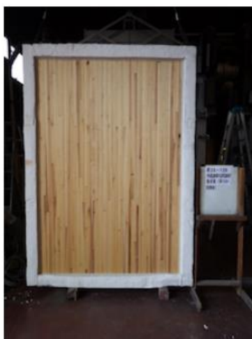
写真1 加熱開始時の加熱面側の様子
