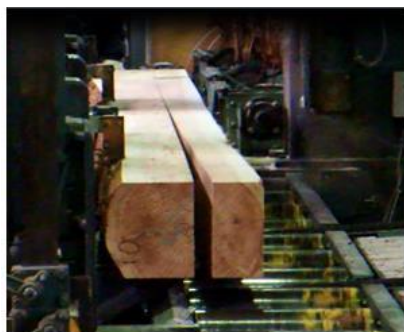
写真1 心去り平角の製材時の曲がり
